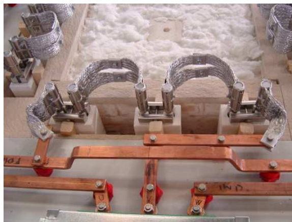
Terminali elementi riscaldanti in disiliciuro di molibdeno e collegamenti di potenza
