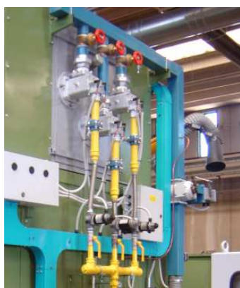
Impianto di combustione a riscaldamento indiretto, a gas, con tubi radianti
