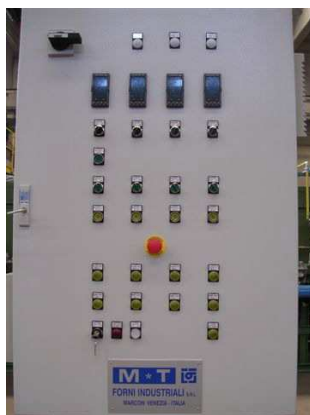
Quadro elettrico di controllo e regolazione
