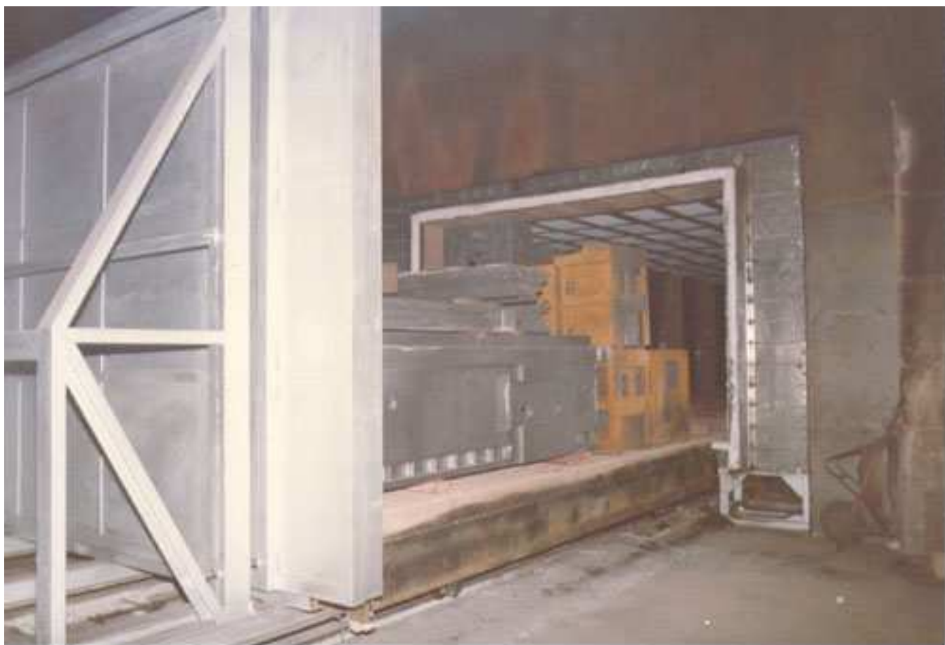
Forno a carro per fusioni in ghisa, lunghezza carro 14 mt, tipo a circolazione d'aria forzata
