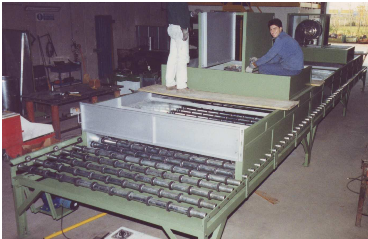
Forno di essiccazione a rulli, a gas, riscaldamento diretto, larghezza rulli 1,8 mt
